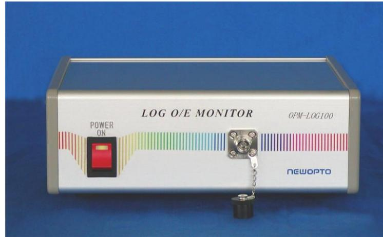
本器は、対数変換したO/E変換器です。光量が1000倍 1万倍と大幅に変化する時にレンジの切り替えなしでアナログ出力します。通信関係の調芯システム、自然界の光量測定 バイオ・生体よりの微弱光の受光と色々な応用があります。可視と長波長により受光素子を選択します。ファイバー入力その他 空間光用も対応します。多チャンネルも製作致します。
